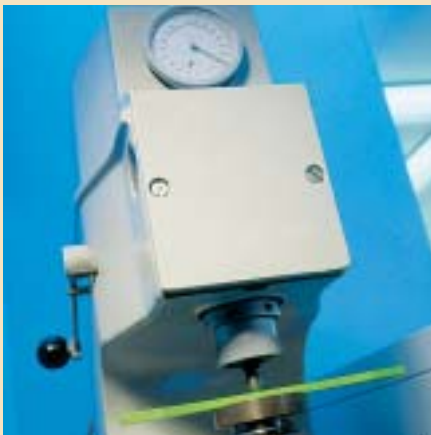
Apparatur zur Bestimmung der Kugeldruckhärte
