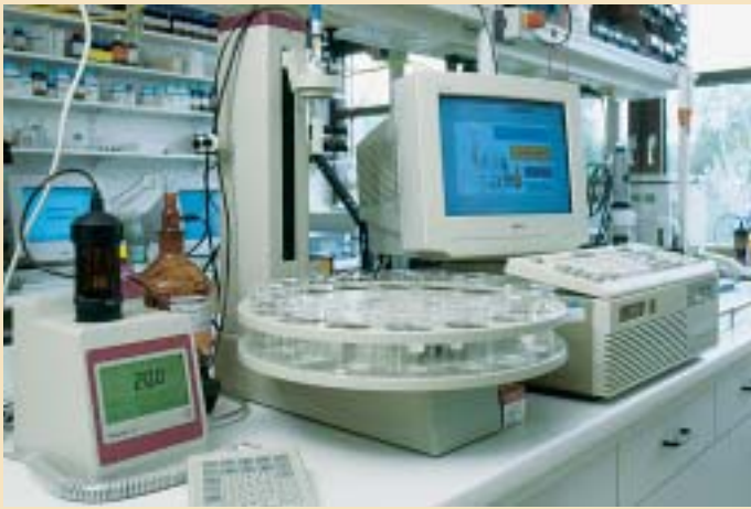
Potentiometrische Titration: Endgruppenbestimmung und Nachweis auf eingearbeitete Halogene
