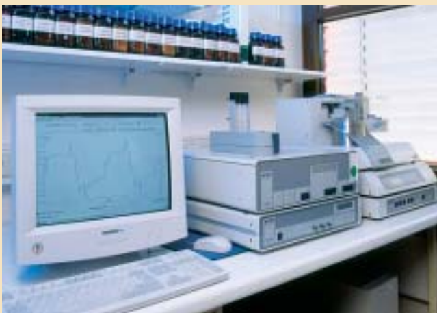
Leistungskalorimeter (Differential Scanning Calorimetry DSC): Charakterisierung der thermischen Eigenschaften und der thermischen Materialvorgeschichte
