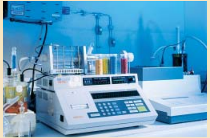
Feuchtigkeitsmessgerät: Verifikation des Feuchtigkeitsgehaltes vor Materialauslieferung und nach Materialkonditionierung für mechanische Prüfungen
