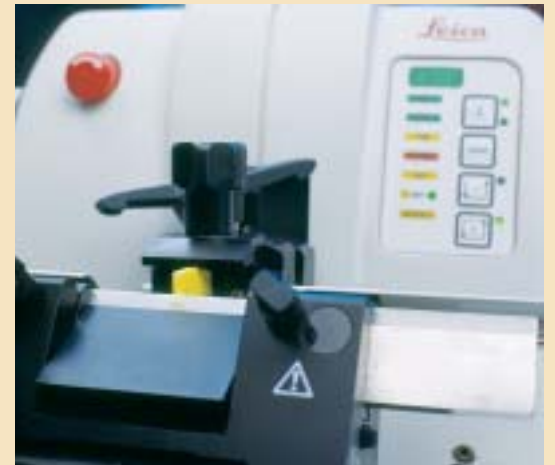
Mikrotom: Präparation von Dünnschnitten im \mu\text{m} -Bereich zur anschließenden mikroskopischen Untersuchung
