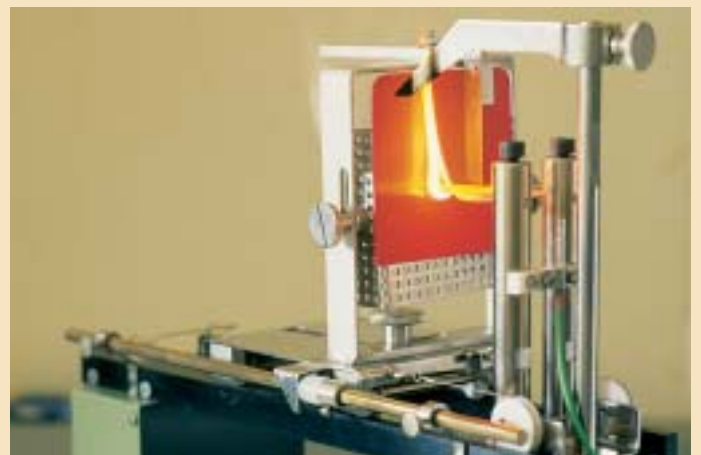
Glühdrahtprüfung: Brandschutztechnische Prüfung für den Einsatz in der Elektrotechnik
